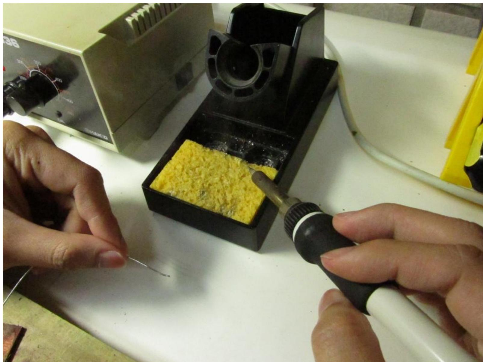
開啟開關後等待加熱完畢，此時將海綿加水沾濕，接著烙鐵頭前端沾附一點錫油後接觸焊錫，使焊錫融化附著在烙鐵頭前端上，最後將烙鐵頭前端接觸海綿將焊錫清除，即完成清理步驟。
