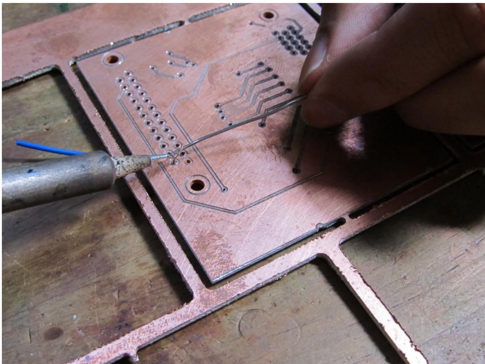
將焊槍與焊錫接近焊點（要焊接的地方），接著焊槍輕觸焊錫使焊錫融化，融化狀態下將焊錫接觸要焊點，使融化的焊錫附著至焊點。
